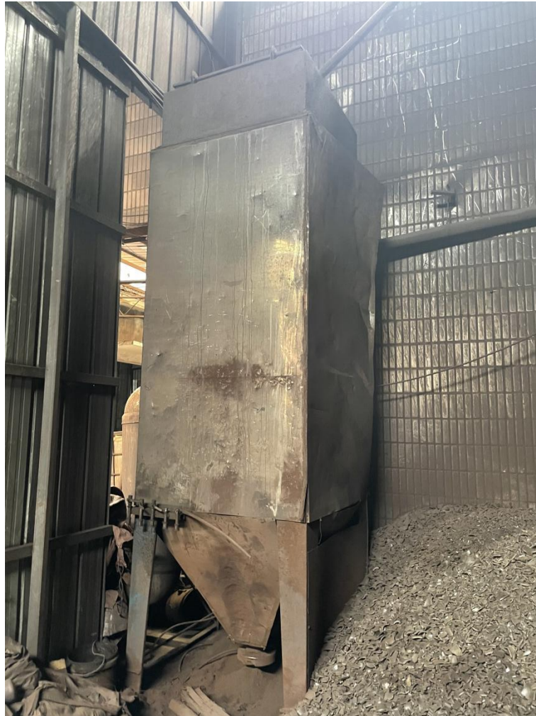
图 3-2 脉冲布袋除尘器
